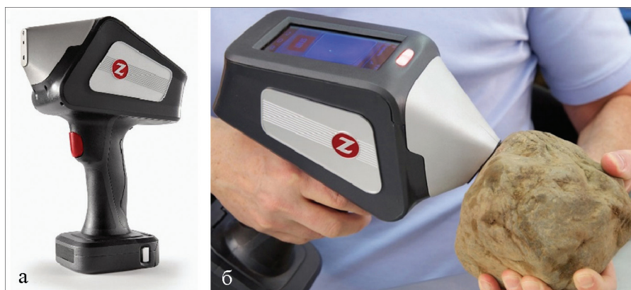
Рис. 1. Анализатор Laser-Z (а) и измерение состава отдельного образца породы (б).
