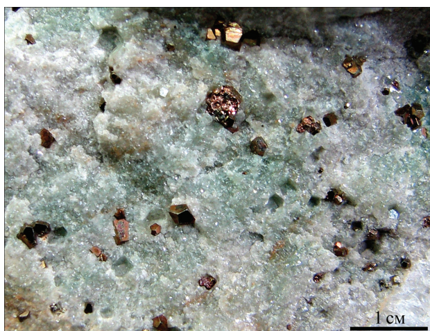
Рис. 1. Плёнки гётита (коричневые) на поверхности и по трещинам метакристаллов пирита в листвените Берёзовского месторождения (Средний Урал).
