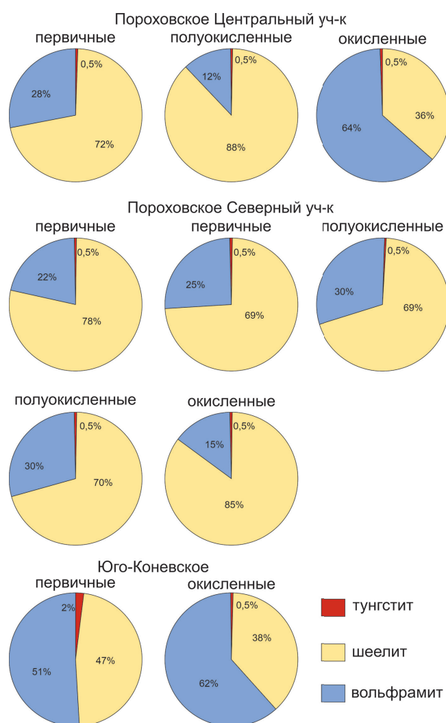
Рис. 4. Соотношение основных форм W по результатам фазового химического анализа.
