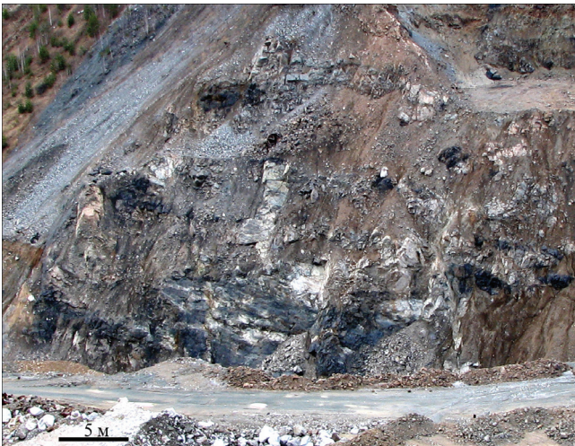
Рис. 7. Карбонатитовые тела (светлое) среди магнетитовых тел (темное) в уступе карьера Меднорудянского месторождения. 2013 год.
