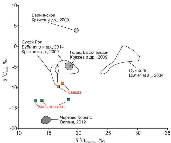
Рис. 6. Изотопный состав кислорода и углерода карбонатов месторождений Копыловское и Кавказ в сравнении с опубликованными данными по  $\delta^{18}\text{O}$  и  $\delta^{13}\text{C}$  для месторождений Сулой Лог, Голец Высочайший, Вернинское, Чертово Корято.
