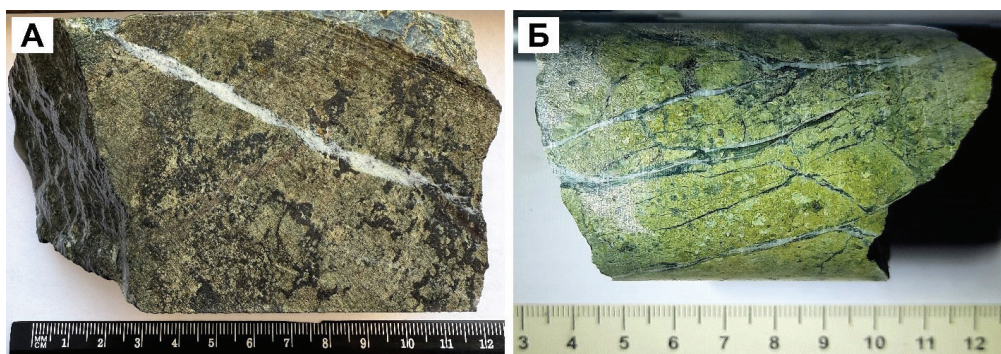
Рис. 3. Гранатовый экоскарн с магнетитом, карбонатом и сульфидами (А) и гранатовый эндоскарн с хлоритом и карбонатом (Б), Новониколаевское месторождение.
